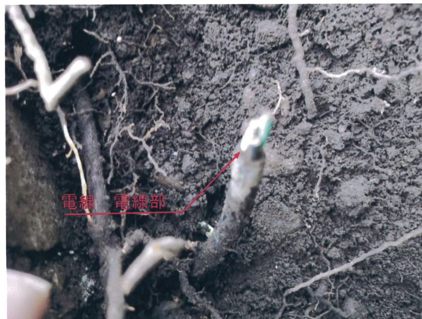
© 照明器具側 電線断線部
