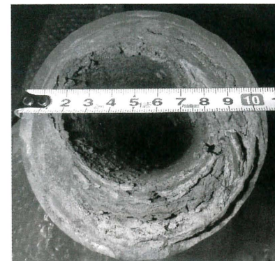
写真1 築47年のマンションの排水立て管汚水・雑排水合流の排水立て管鉄管φ100mm。今まで流れていたのが不思議なぐらい閉塞している。原因の詳細はここでは解説できないが1階から3階まで密実に詰まっていた。
