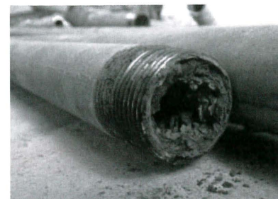
写真2 管内の腐食が進行しており、リフォーム工事と合わせて更新
