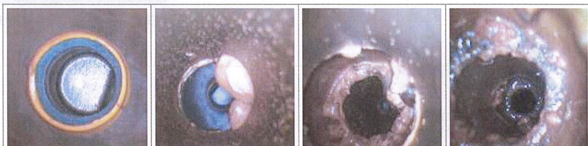
写真-5 給水主管継手部のCCDカメラ画像
